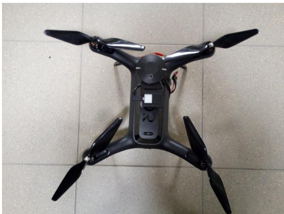
Rysunek 7. Platforma UAV 3DR Solo przenosząca kamerę wielospektralną
