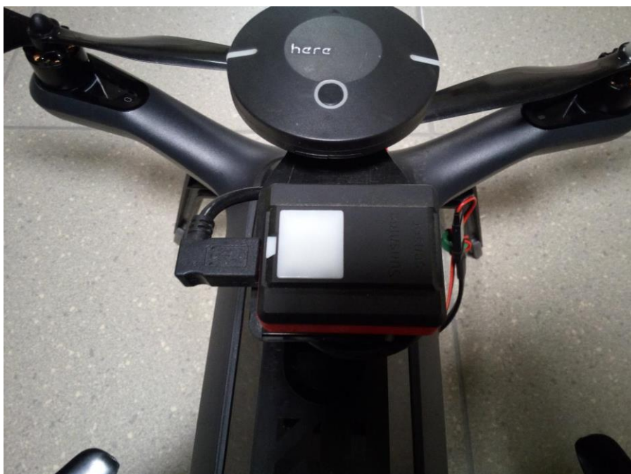
Rysunek 9. Czujnik światła padającego kamery Parrot Sequoia.
