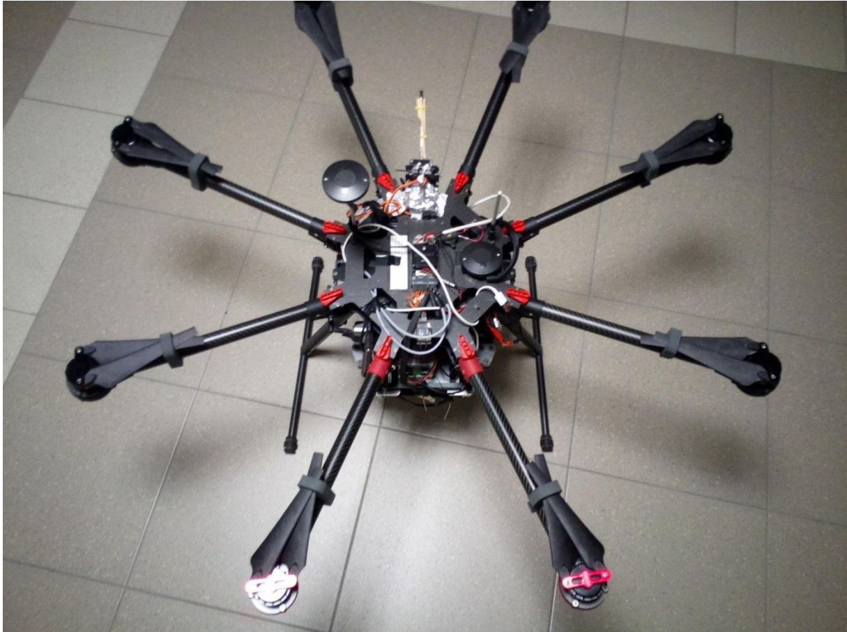
Rysunek 10. Platforma UAV DJI S1000+ przenosząca rejestrator termalny.
