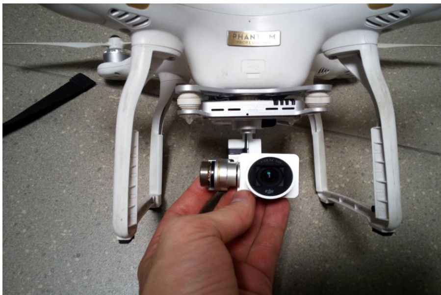
Rysunek 6. Gimbal wraz z kamerą RGB
