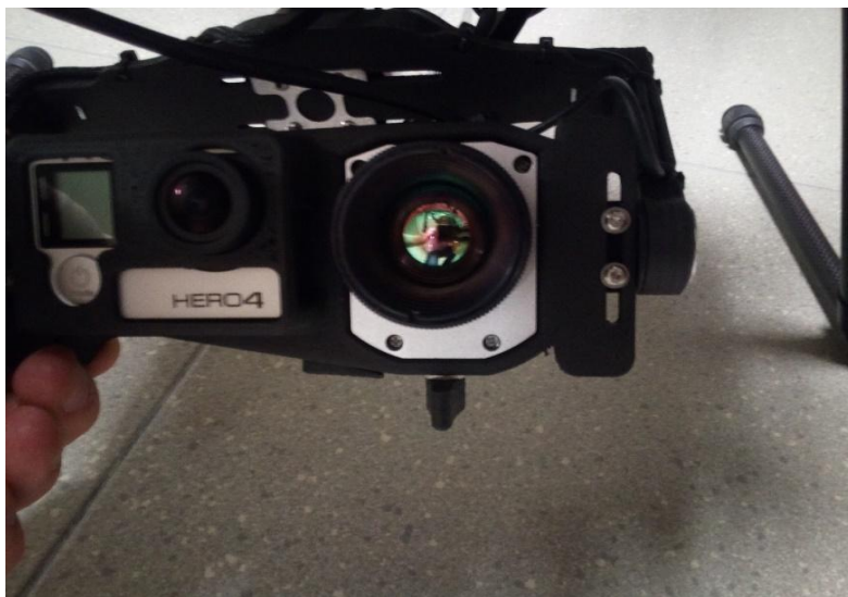
Rysunek 11. System stabilizatora wraz z kamerą termalną.
