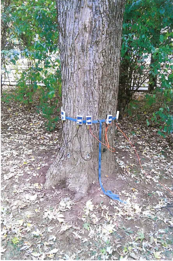
Badanie drzewa przy użyciu sonicznego tomografu na wysokości 37 cm
