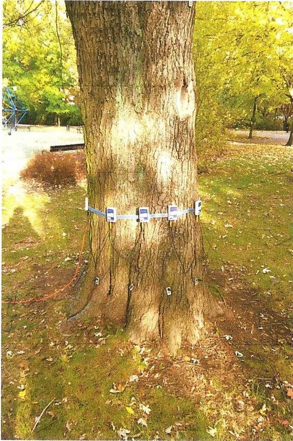
Badanie drzewa przy użyciu sonicznego tomografu na wysokości 28 cm
