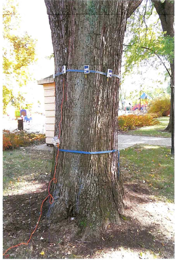
Badanie drzewa przy użyciu sonicznego tomografu na wysokości 205 cm
