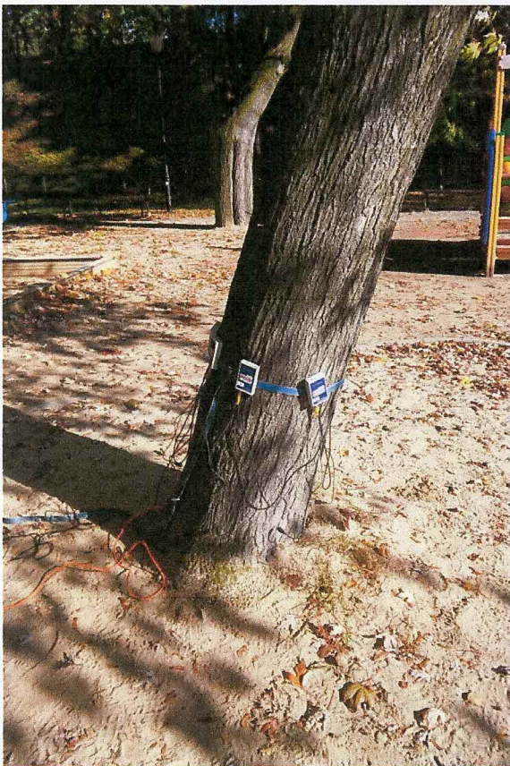
Badanie drzewa przy użyciu sonicznego tomografu na wysokości 30 cm
