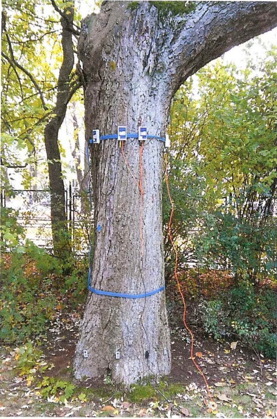
Badanie drzewa przy użyciu sonicznego tomografu na wysokości 209 cm
