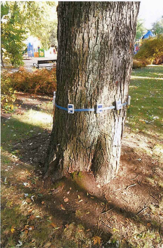
Badanie drzewa przy użyciu sonicznego tomografu na wysokości 36 cm
