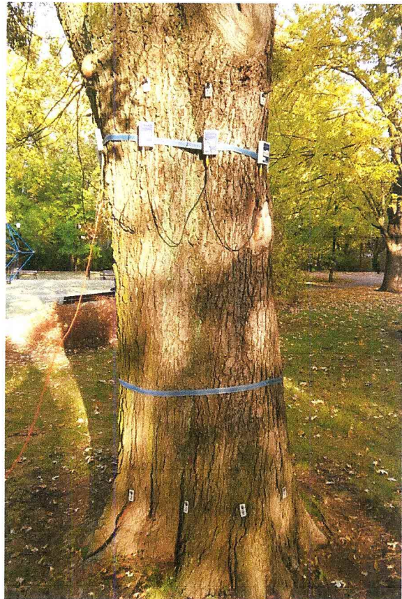
Badanie drzewa przy użyciu sonicznego tomografu na wysokości 201 cm
