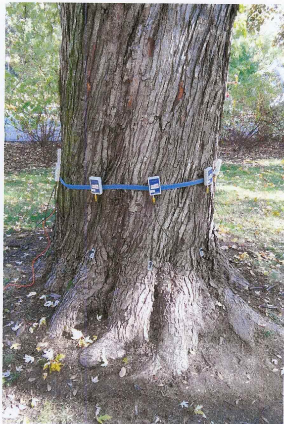
Badanie drzewa przy użyciu sonicznego tomografu na wysokości 38 cm
