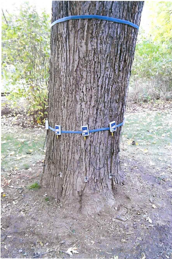
Badanie drzewa przy użyciu sonicznego tomografu na wysokości 27 cm
