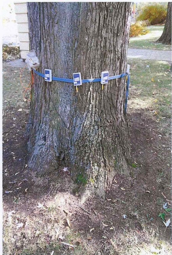
Badanie drzewa przy użyciu sonicznego tomografu na wysokości 33 cm
