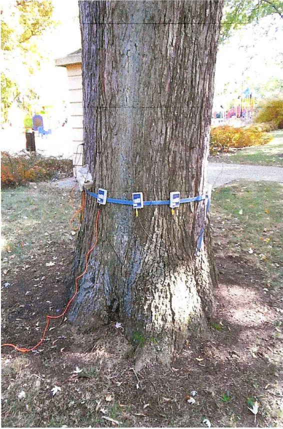
Badanie drzewa przy użyciu sonicznego tomografu na wysokości 110 cm
