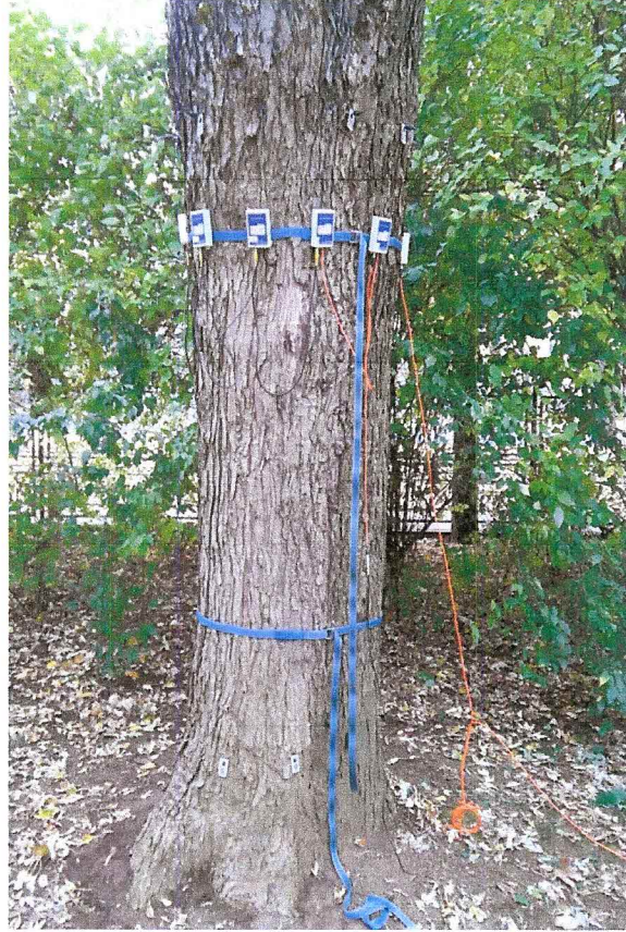
Badanie drzewa przy użyciu sonicznego tomografu na wysokości 216 cm
