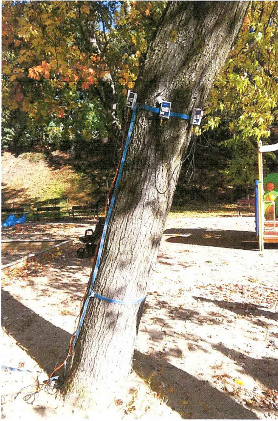
Badanie drzewa przy użyciu sonicznego tomografu na wysokości 211 cm
