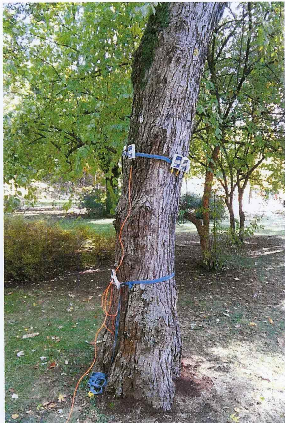
Badanie drzewa przy użyciu sonicznego tomografu na wysokości 192 cm
