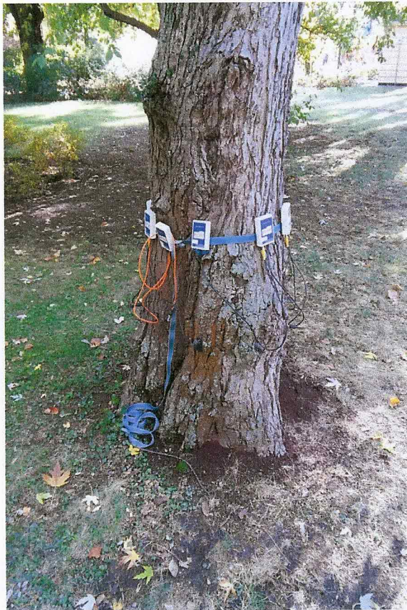
Badanie drzewa przy użyciu sonicznego tomografu na wysokości 45 cm
