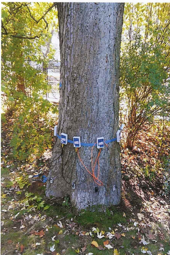
Badanie drzewa przy użyciu sonicznego tomografu na wysokości 22 cm
