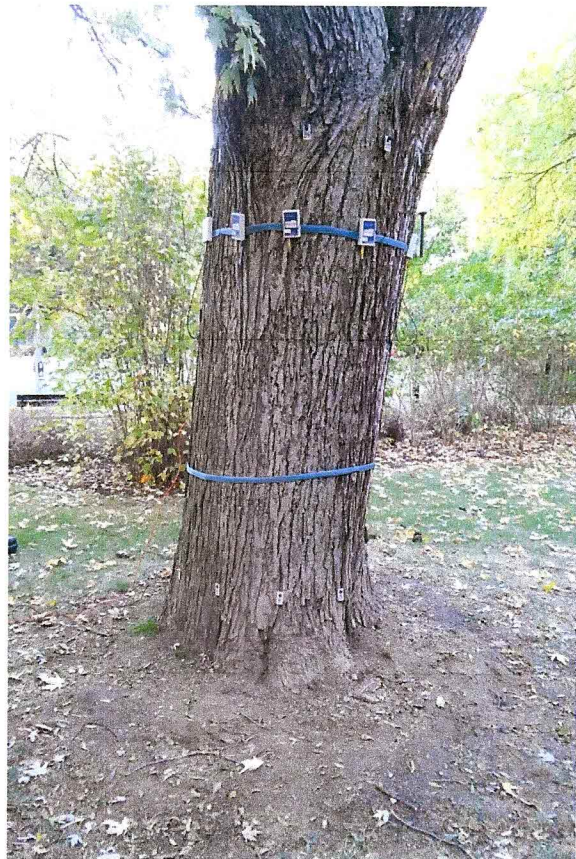
Badanie drzewa przy użyciu sonicznego tomografu na wysokości 204 cm
