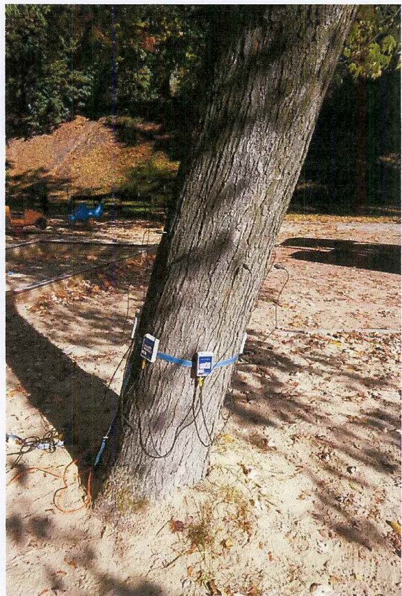
Badanie drzewa przy użyciu sonicznego tomografu na wysokości 124 cm
