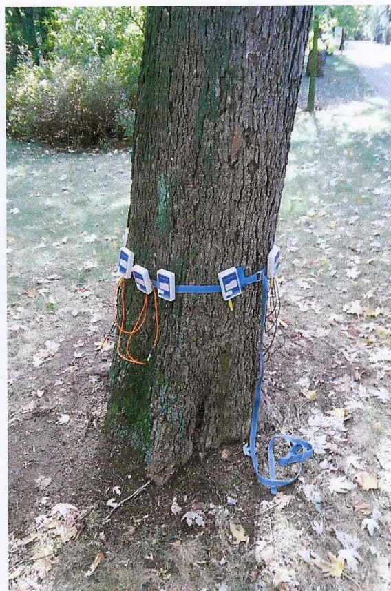
Badanie drzewa przy użyciu sonicznego tomografu na wysokości 25 cm
