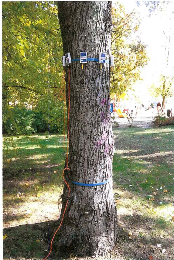
Badanie drzewa przy użyciu sonicznego tomografu na wysokości 212 cm
